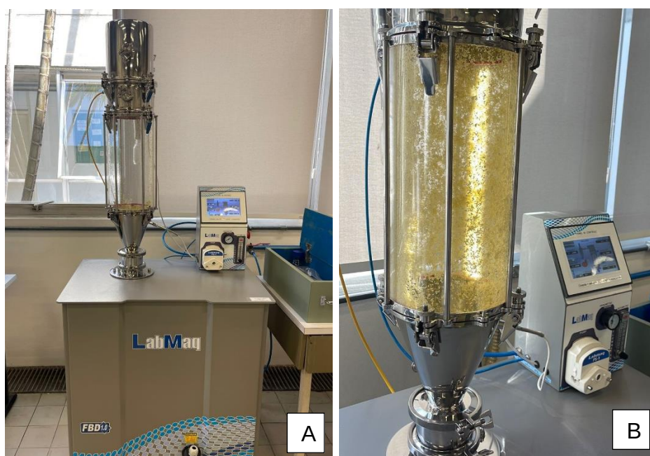
Figura 4. (A) Equipamento de leito fluidizado FBD 1.0; (B) Secagem das micropartículas em leito fluidizado em andamento.
