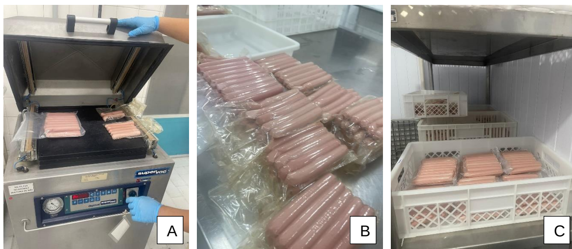
Figura 7. (A) Embalagem a vácuo em seladora Digimat SuperVac TC.114; (B) Identificação das amostras; (C) Armazenamento em câmara de resfriamento.
