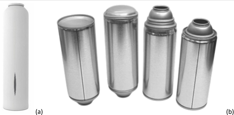
FIGURA 2. Exemplo da forma de ruptura na direção longitudinal de uma embalagem de duas peças de alumínio após ensaio de pressão interna (a) e exemplos de reversão do fundo e do domo de latas de aerossol de três peças – duas latas no centro da imagem (b) (Daehn & Blum, 2004).
